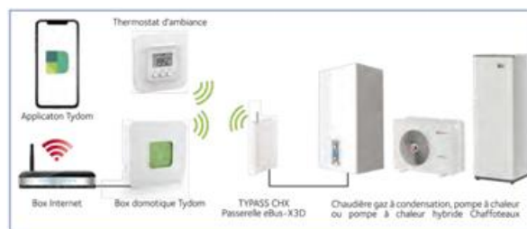
Fonctionnement connectivité Delta Dore du Typass CHX
